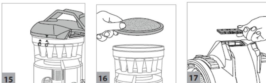
■ NETTOYAGE DU FILTRE DE SORTIE D'AIR :
